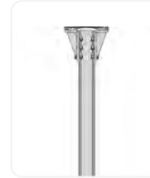
Utilisation de profils de battage IPE et HEA. Aucun profilé par roulage n'est utilisé sur les suiveurs DEGER.
